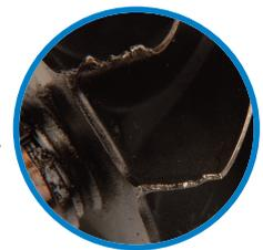
Zerspanung des Verdichters oder der Turbinenschaufeln
